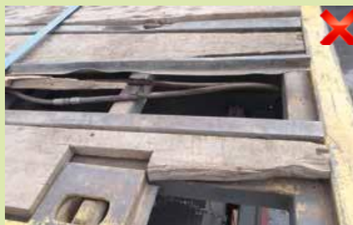
laadvloer in slechte staat
