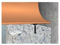
Pour les raccords des tuyaux en PVC-PP, on utilise les joints incorporés et renforcé en caoutchouc qui sont conforme au NBN EN 681-1.
