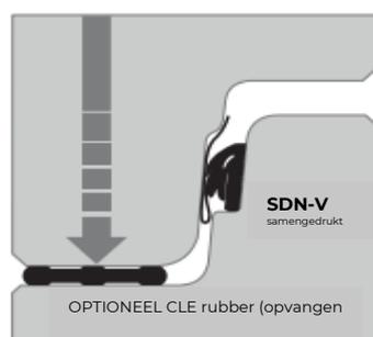
Pour la connexion manchon-embout du chambre de visite on utilise un joint prélubrifié.
