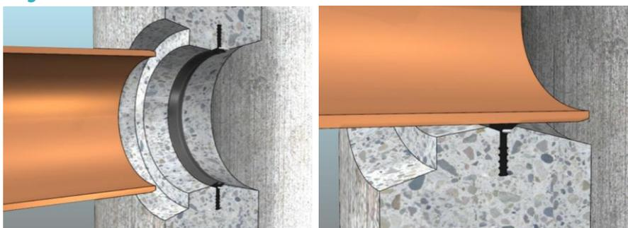
Pour les raccords des tuyaux en PVC-PP, on utilise les joints incorporés et renforcé en caoutchouc qui sont conforme au NBN EN 681-1.
