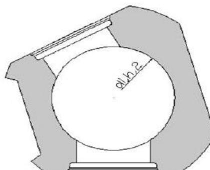
Diamètres de connexions possibles : Ø250 tot Ø800mm. Types de connexions standards : béton, gres, PVC, PP. Autres diamètres et types sur demande.
